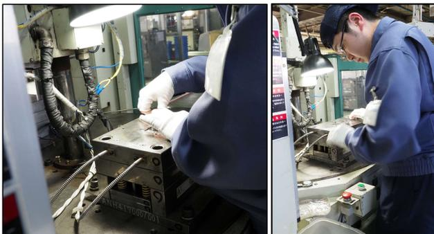
プラスチックに金属を組合せるインサート成形
