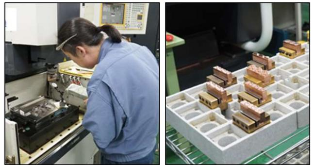
放電加工機(左)と使用する電極(右)です
